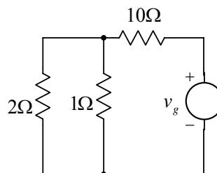
4. [35] Primenom **metode potencijala čvorova** izračunati potencijale svih čvorova u kolu sa slike, kao i struje  $I_A$ ,  $I_B$  i  $I_C$ .
